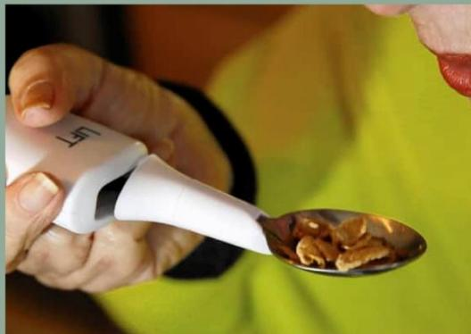
O Liftware Steady é um dispositivo eletrônico acoplado a talheres especiais que visa ajudar pessoas com tremores nas mãos, como os causados pelo Mal de Parkinson, a comer com maior facilidade. O dispositivo ajuda a estabilizar os tremores em até 70%, proporcionando maior conforto e menor constrangimento para os seus usuários.
