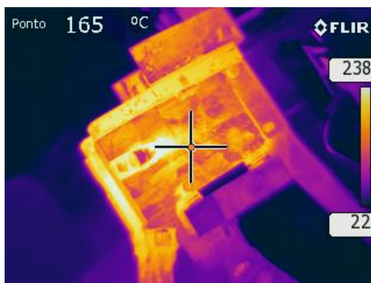
Figura 3: Fotografia do conjunto do injetor de adesivo aquecido em infravermelho (ERPS, 2011).
