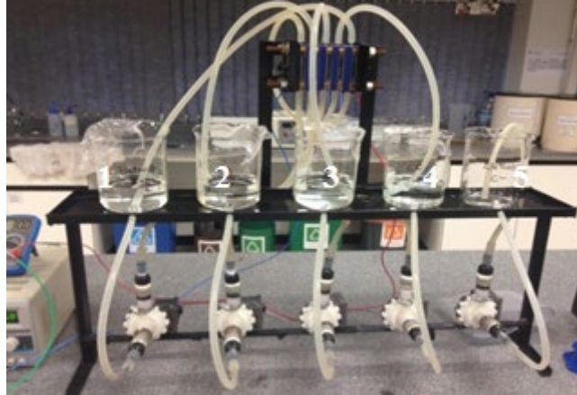
Figura 3 – Equipamento de eletrodialise em escala laboratorial com 5 compartimentos.
